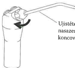
Obrázek 3 Eliminování otáčení koncovky otáčením matice.
