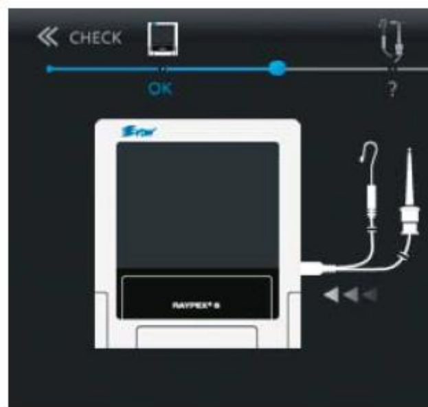
obr. 32 připojení měřicího kabelu
